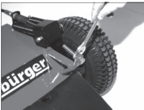
3) Lösen Sie zunächst die Kontermutter.
