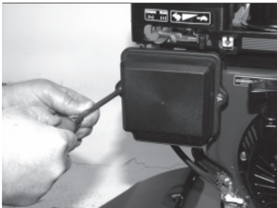
1) Schrauben des Luftfilterdeckels lösen.
