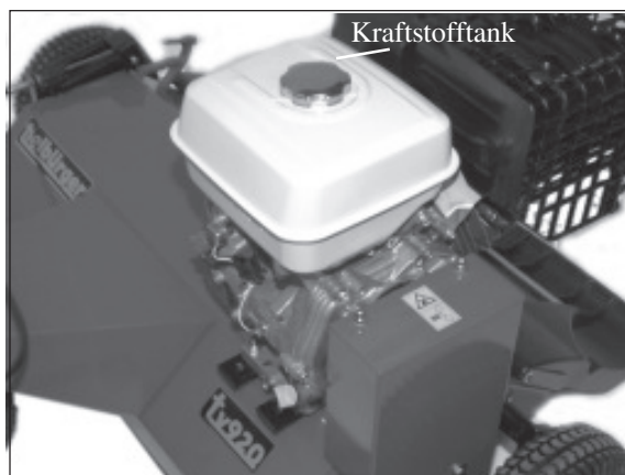
1) Kraftstofftank beim Honda GX-Motor.
