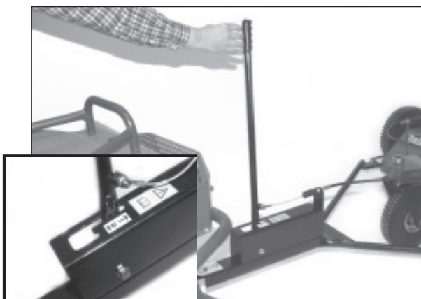
4) Messerantrieb ist eingeschaltet und die Werkzeuge befinden sich in Arbeitsposition.
