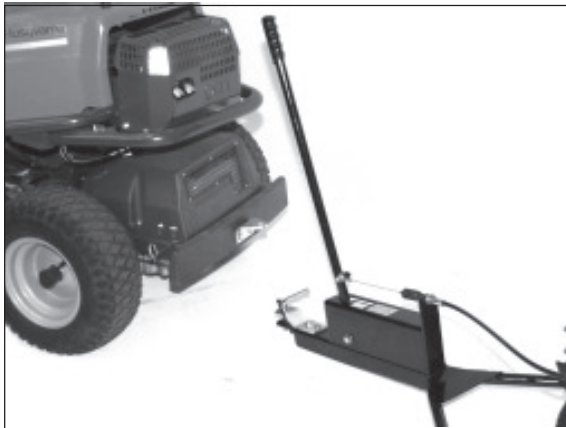
1) Deichsel des Vertikutierers zur Anhängerkupplung der Zugmaschine ziehen.
