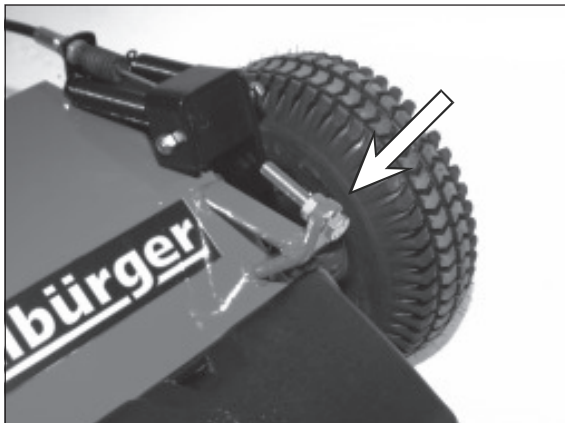
1) Einstellschraube der Vertikutiertiefe.
