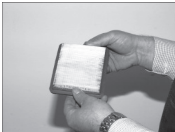
4) Lamellen vorsichtig ausklopfen oder mit Pressluft reinigen.
