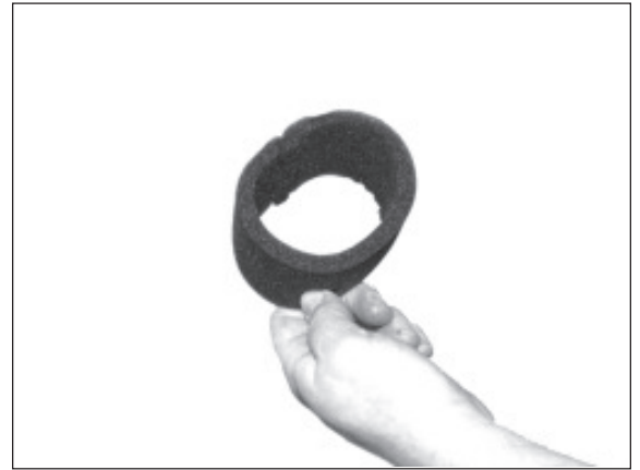
10) Grobfilter vorsichtig ausklopfen oder mit Pressluft reinigen.
