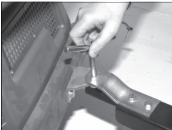
3) Kupplung der Zugmaschine und die des Vertikutierers in Deckungsgleichheit bringen und Bolzen durchstecken.
