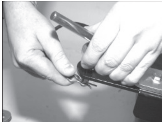
2) Federstecker entfernen und Bolzen durchstecken.
