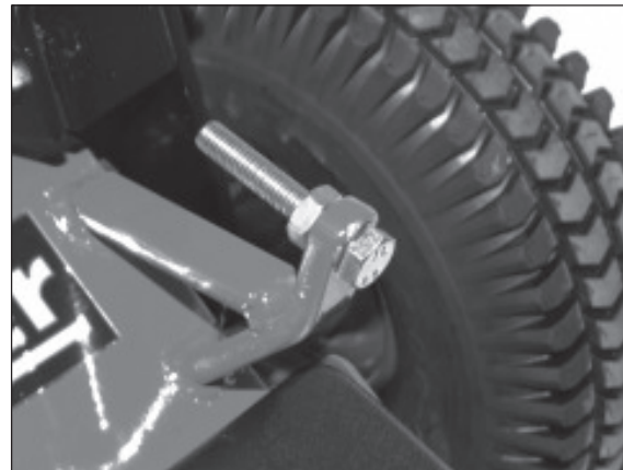
2) Höchste Messerstellung bzw. geringe Eindringtiefe der Messer.
