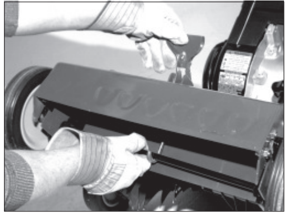
4) Nun die Verriegelung nach unten drücken.
