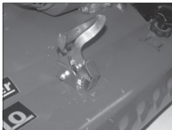
6) Die Entriegelung nach oben klappen.
