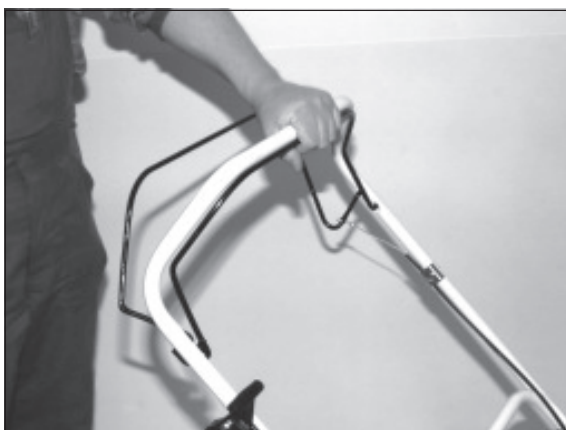
1) Durch Ziehen des Sicherungsbügels und anschließend drücken des Schaltbügels wird der Messerantrieb eingeschaltet.
