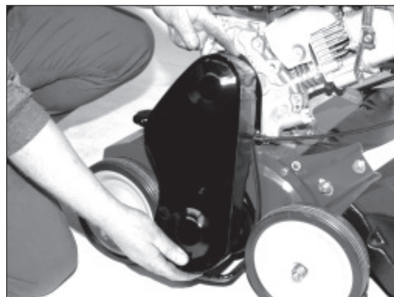
2) Entfernen Sie den Keilriemenschutz.
