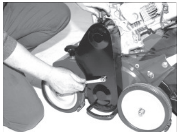
8) Abschließend den Keilriemenschutz aufsetzen und festschrauben.
