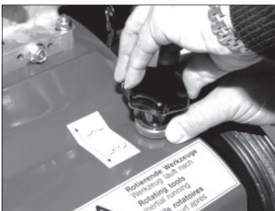
5) Kontermutter wieder festdrehen, Einstellschraube dabei festhalten.
