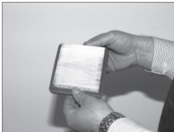
4) Lamellen vorsichtig ausklopfen oder mit Pressluft reinigen.
