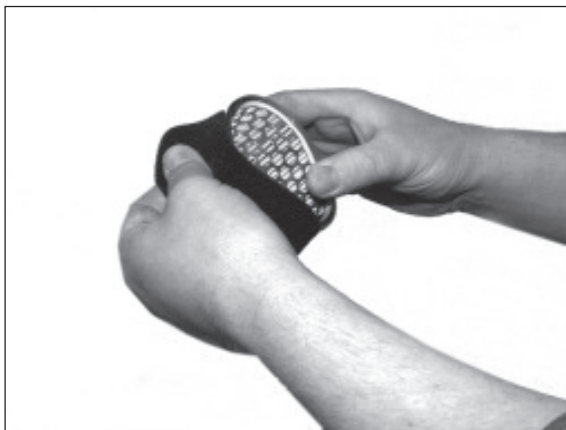
5) Vorsichtig den Grobfiltere abnehmen und die Lamellen reinigen.
