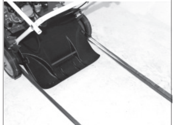
2) Transport mit einem Kraftfahrzeug: Befestigen Sie das Gerät mit Spannrriemen. Vorder- und Hinterachse dienen als Befestigungspunkte.
