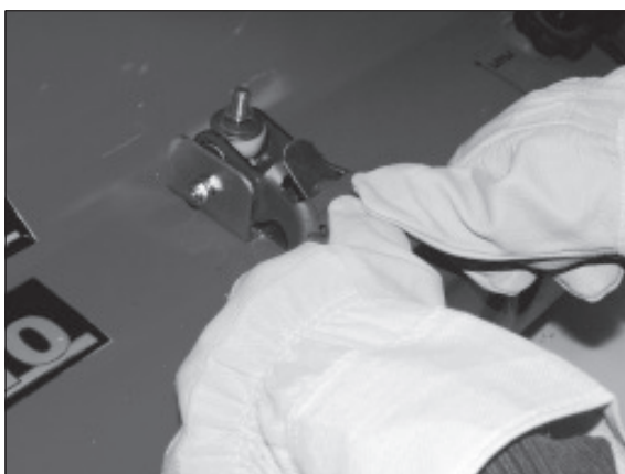
5) Nun die Verriegelung nach unten drücken bis die Sicherung greift.
