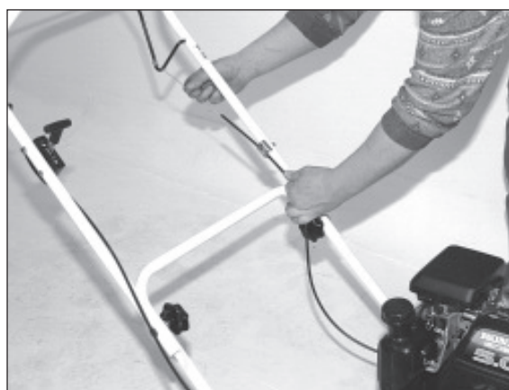
2) Bowdenzug nach unten ziehen, so dass er leicht auf Zug steht.
