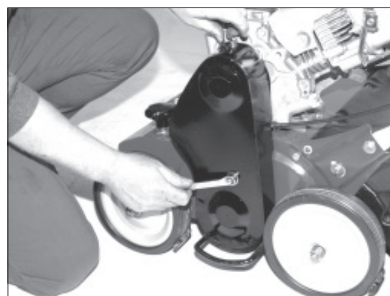
8) Abschließend den Keilriemenschutz aufsetzen und festschrauben.
