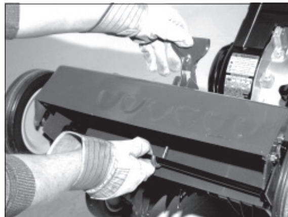
4) Nun die Verriegelung nach unten drücken.
