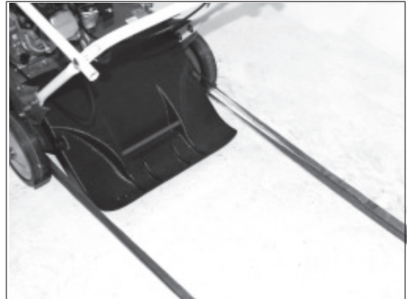
2) Transport mit einem Kraftfahrzeug: Befestigen Sie das Gerät mit Spannrriemen. Vorder- und Hinterachse dienen als Befestigungspunkte.
