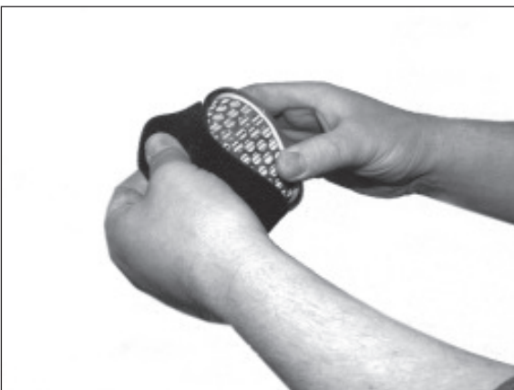
5) Vorsichtig den Grobfiltere abnehmen und die Lamellen reinigen.
