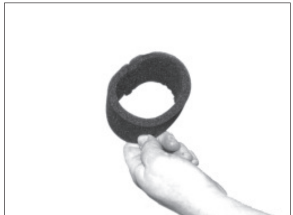
6) Grobfilter vorsichtig ausklopfen oder mit Pressluft reinigen.
