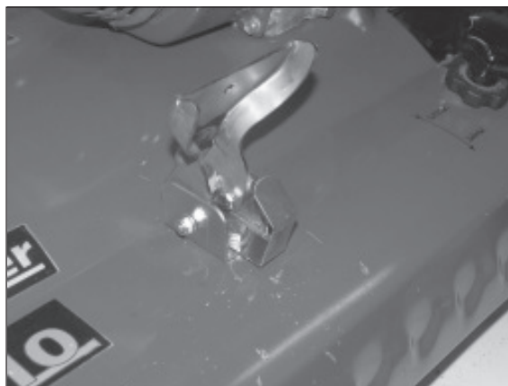
6) Die Entriegelung nach oben klappen.
