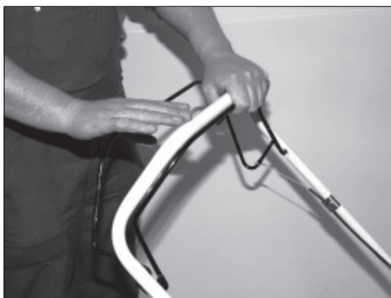
1) Ist deutlich ein Leerweg zu spüren, muss der Bowdenzug eingestellt werden.
