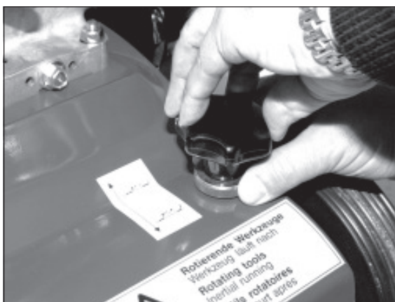
5) Kontermutter wieder festdrehen, Einstellschraube dabei festhalten.
