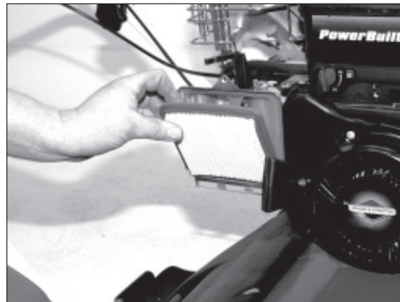
4) Lamellen vorsichtig ausklopfen oder mit Pressluft reinigen.
