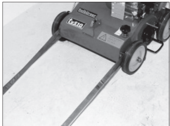
4) Vorder- und Hinterachse dienen als Befestigungspunkte. Führung des Spannrriemens vorne.
