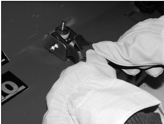
5) Nun die Verriegelung nach unten drücken, bis die Sicherung greift.
