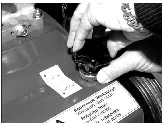
5) Kontermutter wieder festdrehen, Einstellschraube dabei festhalten.
