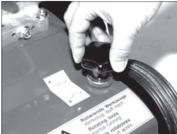
3) Beim Drehen der Einstellschraube wird die Vertikutiertiefe eingestellt.
