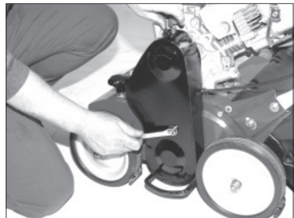
8) Abschließend den Keilriemenschutz aufsetzen und festschrauben.
