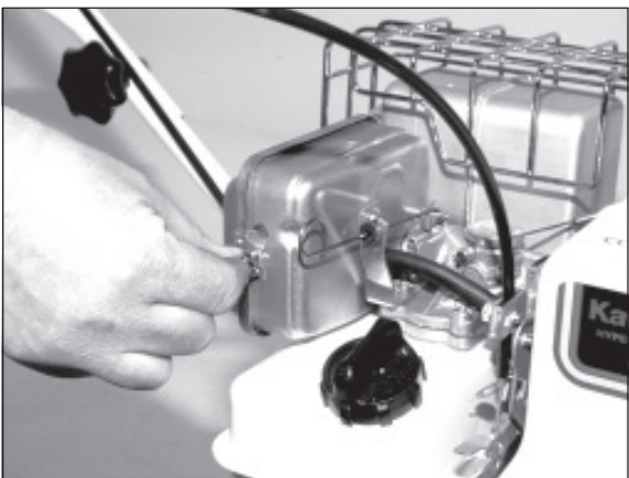
1) Schraube des Luftfilterdeckels lösen.
