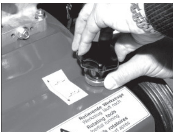
5) Kontermutter wieder festdrehen, Einstellschraube dabei festhalten.
