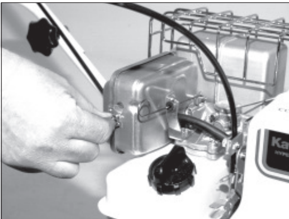
1) Schraube des Luftfilterdeckels lösen.
