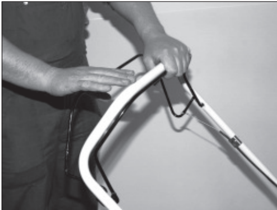
1) Ist deutlich ein Leerweg zu spüren, muss der Bowdenzug eingestellt werden.
