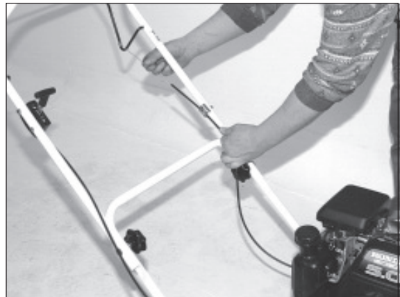
2) Bowdenzug nach unten ziehen, so dass er leicht auf Zug steht.
