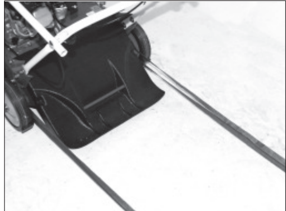
2) Transport mit einem Kraftfahrzeug: Befestigen Sie das Gerät mit Spannriemen. Vorder- und Hinterachse dienen als Befestigungspunkte.
