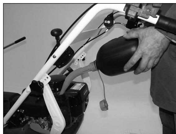
2) Halten Sie den Kanister wie auf dem Bild. Füllen Sie nur jeweils eine geringe Menge ein und kontrollieren Sie die Füllhöhe.
