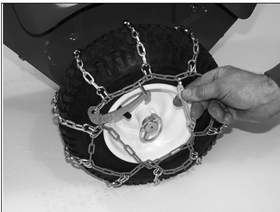
3) Die Kette um das Rad legen und mit dem Spanner quer über das Rad spannen und einhaken.
