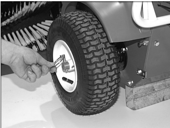
1) Zunächst die Maschine mit einem Kantholz aufbocken und anschließend das Rad abnehmen.
