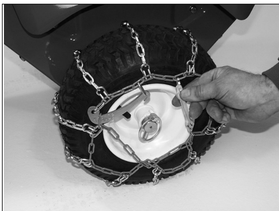
4) Die Kette um das Rad legen und mit dem Spanner quer über das Rad spannen und einhaken.
