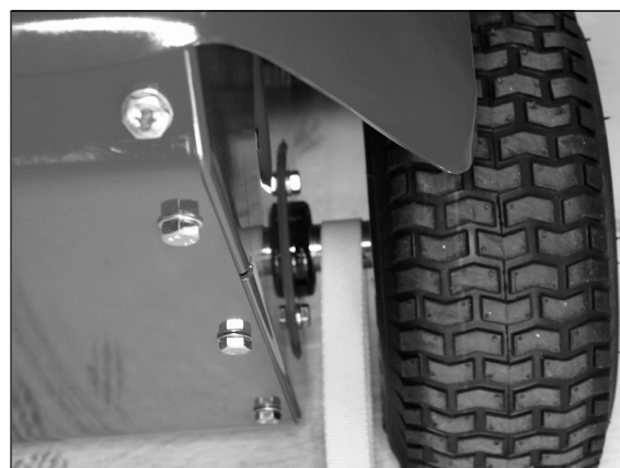
2) Die Hinterachse dient als Befestigungspunkt
