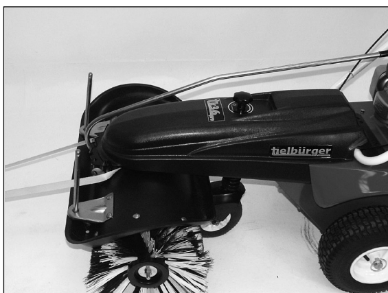
1) Führung des Spannriemens vorne.
