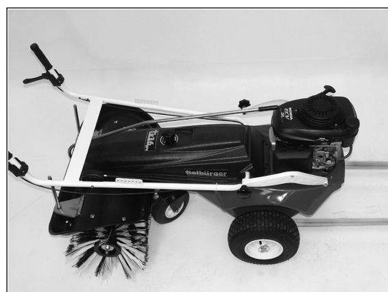
4) Der Lenker wird ganz nach vorne geklappt.
