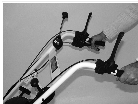
2) Solange Sie den Schalthebel drücken, fährt die Maschine rückwärts.
