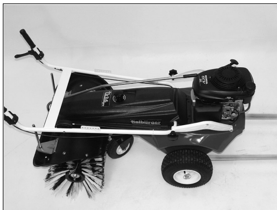
4) Der Lenker wird ganz nach vorne geklappt.
