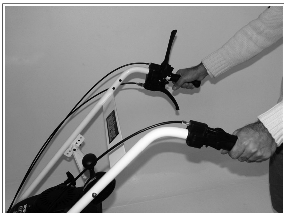
3) Mit der linken Hand wird die Kehrbürste eingeschaltet.
