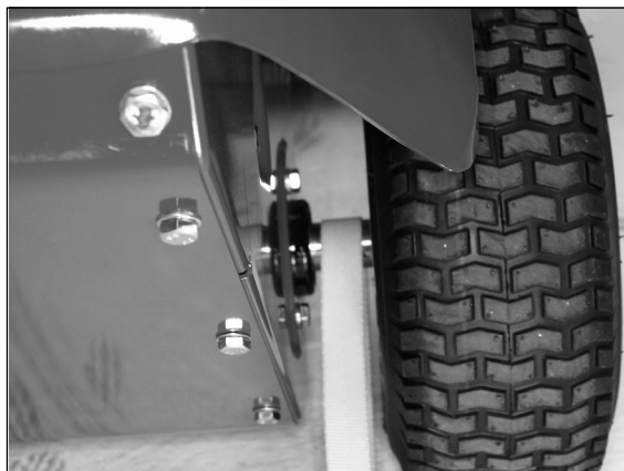
2) Die Hinterachse dient als Befestigungspunkt
