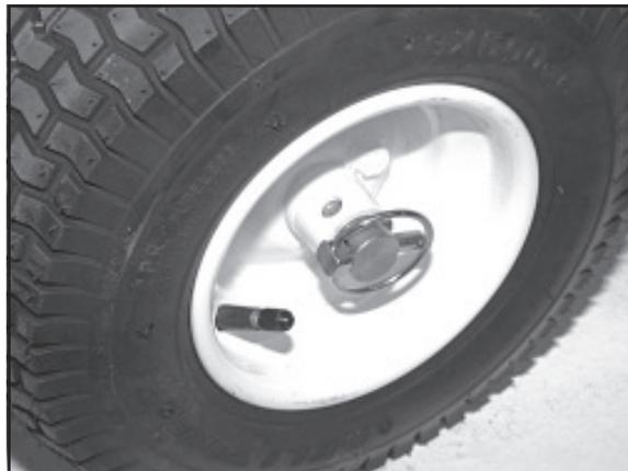
2) Wendefreilauf einschalten: Klappsplint nur durch die Achse stecken.
