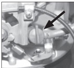
2) Beim **Honda-Motor** muss der Kraftstoffhahn (in Fahrtrichtung links am Motor) geschlossen werden.
