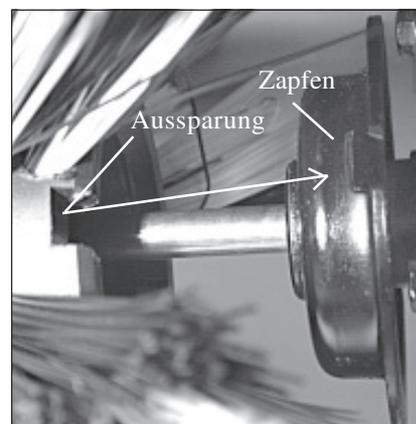
6) **Montagehinweis.** Die Aussparung an der Kkehrbürste wird an den Zapfen am Getriebe gesetzt.
