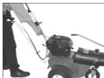
3) Ziehen am Starterseil. Achten Sie darauf, dass Sie hinter dem Lenker und außerhalb der Gefahrenzone stehen.
