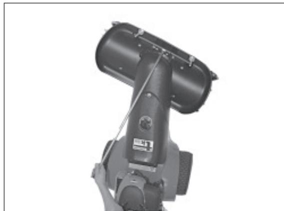
2) Heben Sie den Schwenkhebel aus der vorderen Verzahnung, so dass der Hebel austrastet. Drehen Sie die Bürste in die gewünschte Richtung und lassen Sie den Hebel wieder sicher einrasten. Hier: Wurfrichtung rechts.
