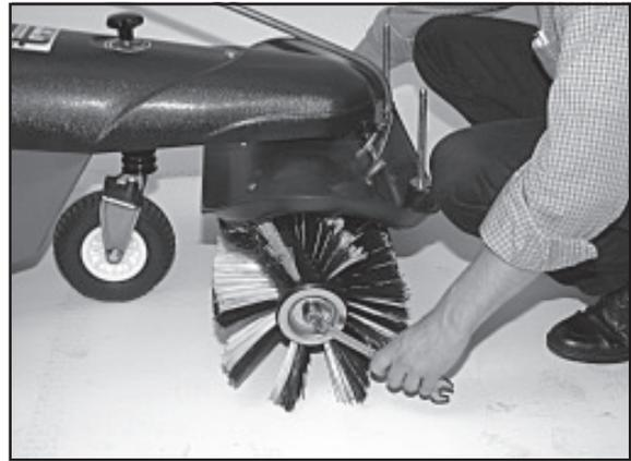
10) Nun die Kkehrbürsten mit der Sicherungsmutter festziehen. (Mutter am anderen Ende der Achse festhalten)
