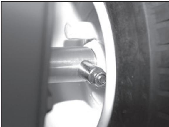
1) Die Kehrmaschine ist mit einem Wendefreilauf ausgestattet. Hierdurch wird das Wenden der Kehrmaschine erleichtert.
