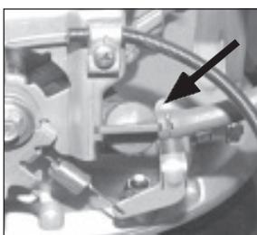
2) Beim **Honda-Motor** muss der Kraftstoffhahn (in Fahrtrichtung links am Motor) geöffnet werden.
