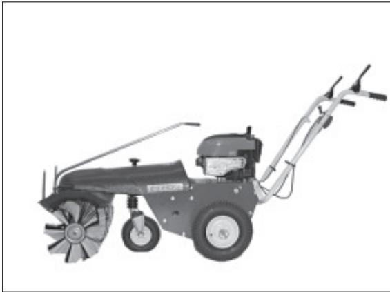
1) Bitte überprüfen Sie regelmäßig den Reifenfülldruck des Stützrades und der Antriebsräder.
