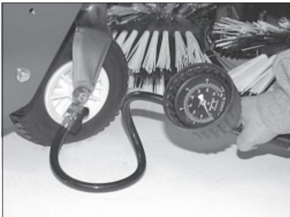
2) Stützrad: 2 bar. Bei Kopfsteinpflaster kann der Luftdruck auf 1,5 bar gesenkt werden.
