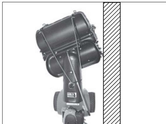
4) Mit Kehrgutbehälter ist eine seitliche Einstellung empfehlenswert. Dadurch kann selbst mit Kehrgutbehälter wandenschlüssig (z. B. an der Hauswand, am Bordstein) gekehrt werden.
