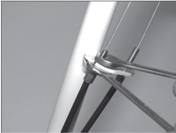
1) Die obere Mutter mit einem 10er-Maulschlüssel um ca. eine Umdrehung lösen.
