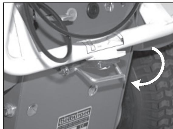
4) Den Lenker nach hinten klappen und einrasten lassen.
