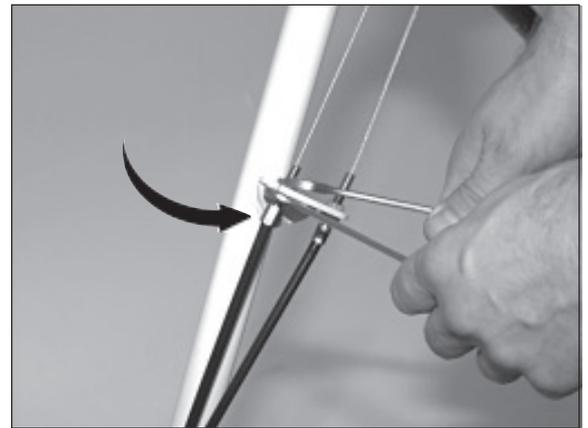
2) Anschließend die untere Mutter festdrehen.
