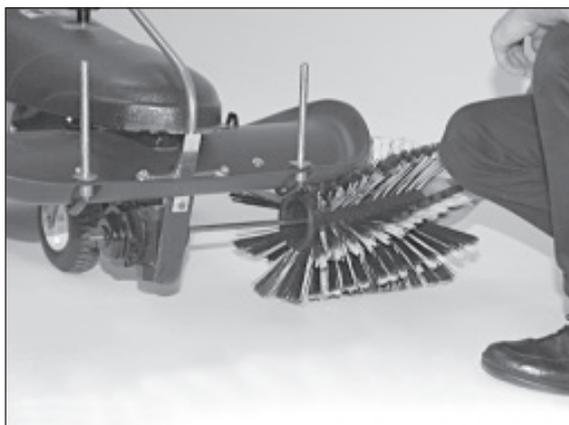
3) Die Achse mit der zweiten Kkehrbürste herausziehen.
