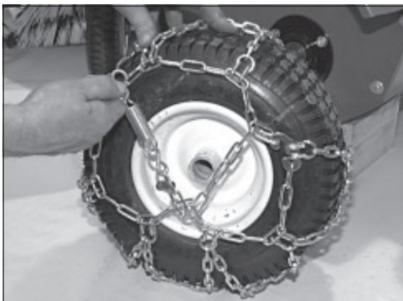
5) Das Kettenende mit der Feder quer über das Rad spannen und einhaken. Die Feder muss dabei leicht unter Spannung stehen.
