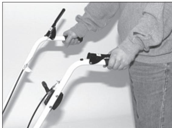
2) Mit der linken Hand wird die Kkehrbürste eingeschaltet.
