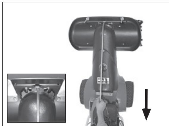
6) Beim Rückwärtsfahren mit der Kehrmaschine muss die Kehrbürste immer in gerade Stellung gebracht werden.
