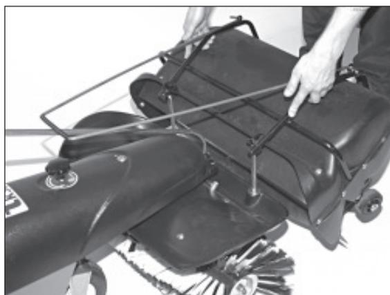
4) Kehrgutbehälter auf die Aufnahmestangen stecken.
