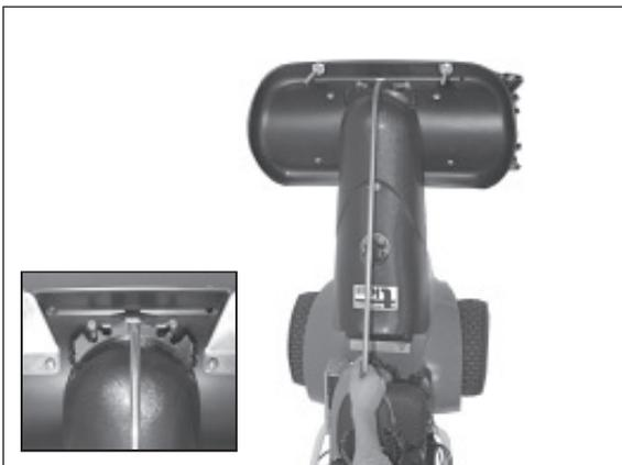
1) Die Wurfrichtung kann 5-fach verstellt werden. Hier: Wurfrichtung nach vorne. Durch diese Stellung häuft sich das Kehrgut vor der Bürste an. Bevorzugen Sie seitliche Bürsteneinstellungen.
