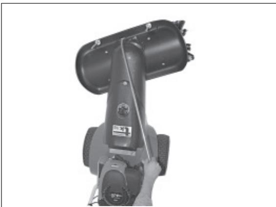
3) Das Kehrgut wird nun seitlich abgelegt bzw. beiseite gekehrt. Diese Einstellung ist besonders für Schnee vorteilhaft, um Gehwege freizumachen. Hier: Wurfrichtung links.
