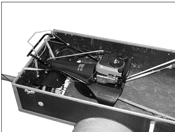
5) Der Lenker wird ganz nach vorne geklappt.
