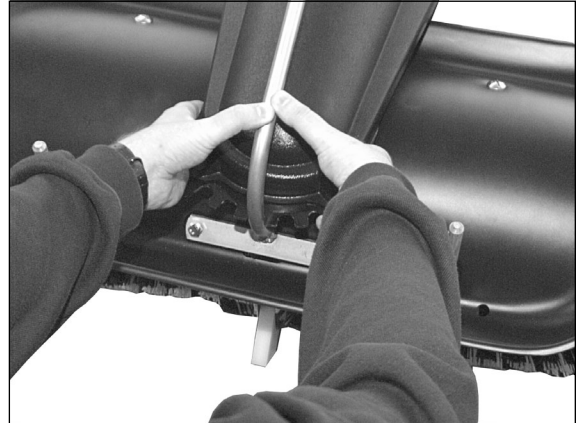
2) Haltepunkte vorne für das Anheben der Maschine.
