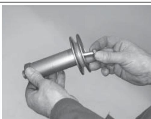
Montage der Keilriemenscheibe des Antriebssatzes. Zollschraube einführen.
