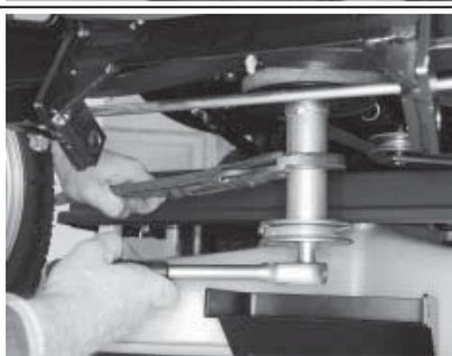
Keilriemenscheibe des Antriebssatzes unter der Keilriemenscheibe des Rasentraktors positionieren und anschließend mit der Schraube montieren.
