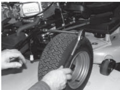
Schrauben, Scheiben und Muttern demontieren. Mit der anderen Seite ebenso verfahren.
