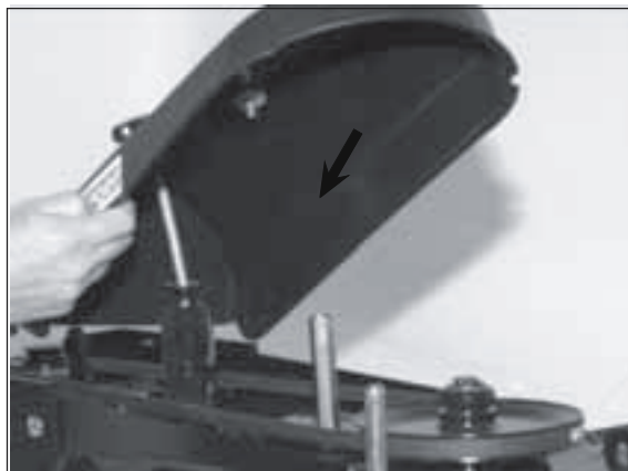
② Der Bürstendruck läßt sich feinstufig einstellen. Das Stützrad ist deshalb in der Höhe verstellbar. Oberhalb des Stützrades befindet sich der Einstellknopf.
