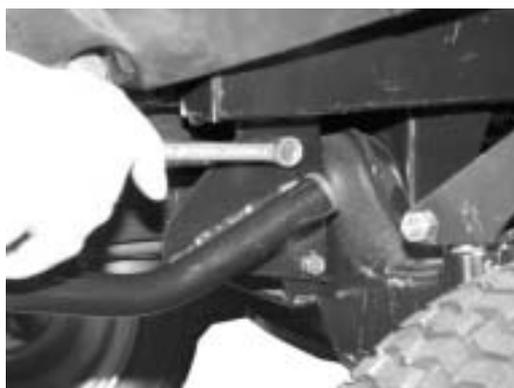
Seitliche Schrauben vom Schutzbügel herausdrehen und Schutzbügel entfernen.
