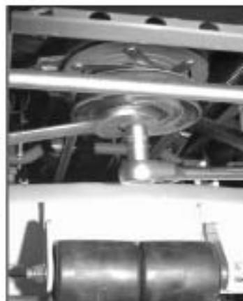
Die Anlageflächen der Keilriemenscheibe und des Druckstücks der Magnetkupplung müssen frei von Aufwerfungen jeder Art sein.
