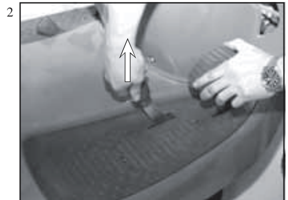
Gummi des Pedals abziehen.
