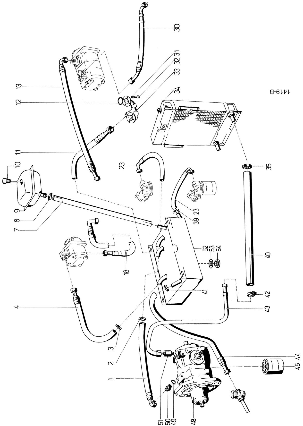
**Tafel 137401    Hydraulikgetriebe, Ölbehälter, Ölkühler    Ausf. Renault 800-45**
